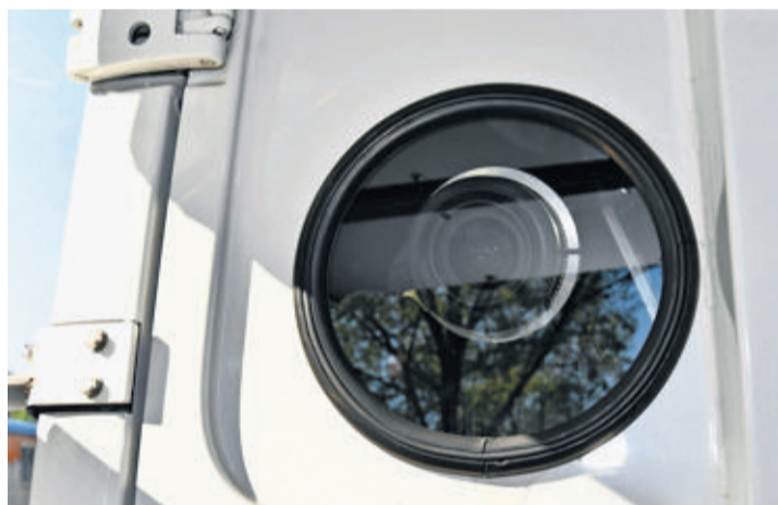
Le véhicule est truffé d'informatique. Ici, gros plan sur une des caméras qui prend la route en photo tous les 5 mètres.
