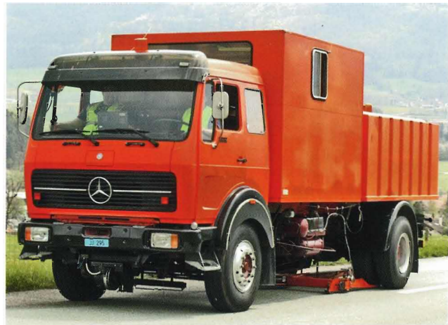
3: Vue du bâti de mesure du déflectographe Lacroix (source SACR SA).
